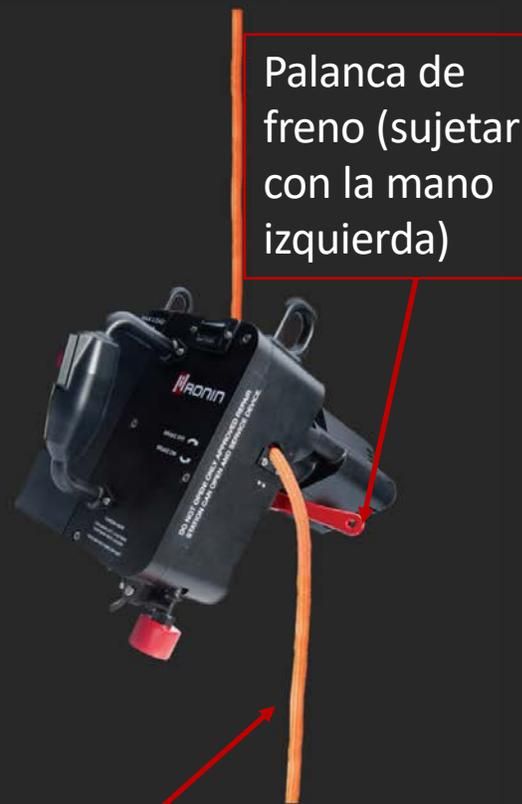
Palanca de freno (sujetar con la mano izquierda)
